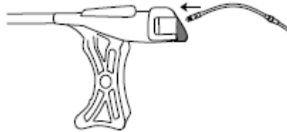
Inserción de un cable precargado
